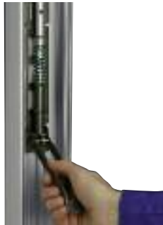
Klemma óspennt: Klemmueiningin er færð í rétta stöðu svo hún passi á hæðina.
