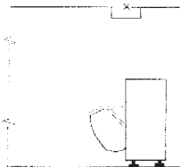
Figur 7 - Lampepunkt i tak i rom for vask og tørk av tøy.
