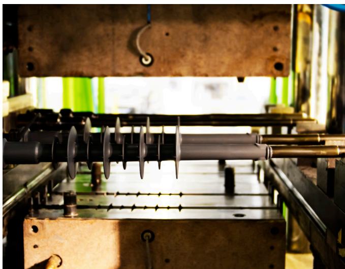
En ögonblicksbild från tillverkning av prefabricerade kabelavslutningar.
