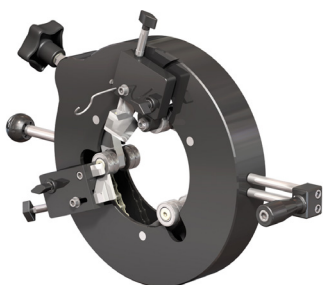
SH 50, SH 80, SH 130 Skalverktyg för skalning och borttagning av kabelns PEX-isolering samt borttagning av yttre ledande skikt. Det finns tre storlekar beroende av diameter över kabelns PEX-isolering enligt tabell nedan.
