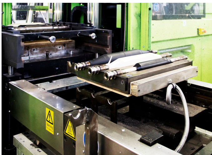
Kabelskarvarnas tre skikt är sammanvulkade i en unik tillverkningsprocess.
