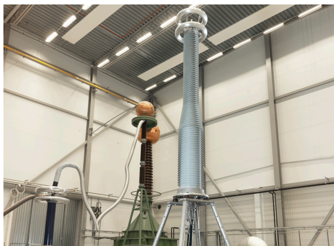
Elektrisk provning av en 420 kV kabelavslutning vid vårt högspänningslaboratorium.
