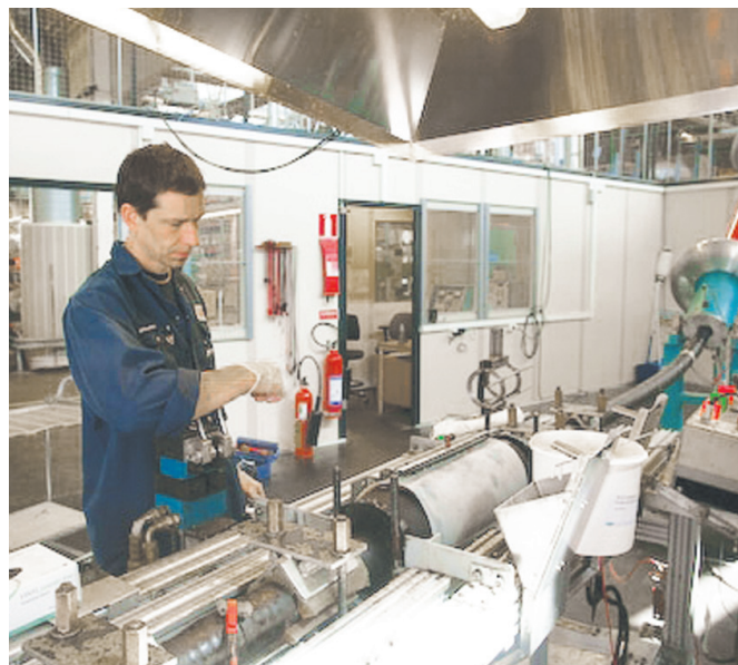
Tillverkning av utomhusavslutningar för pappersisolerade kablar, 1962.
