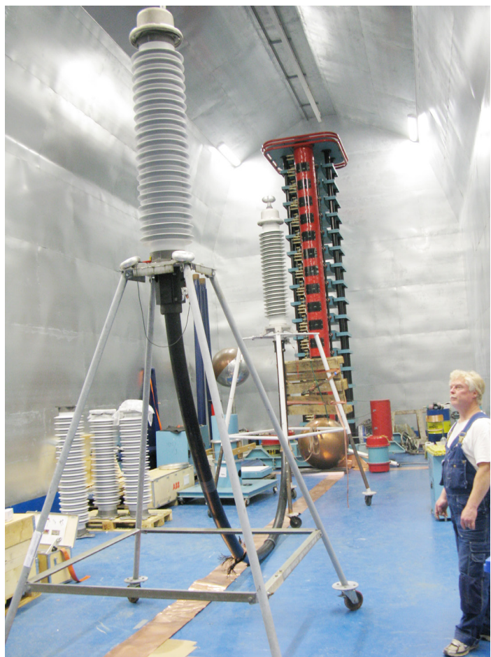
Elektrisk provning av kabelavslutningar TD 145 på oberoende laboratorium.
